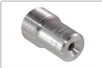
适用于近距离清洗小部件，这种喷嘴的特点是碳化钨内衬被铝护套所包裹，可以提供最大的抗冲击或抗弯曲能力。这些喷嘴配有橡胶垫圈，适合跟Elcometer 1020磨料喷砂机配套使用。
