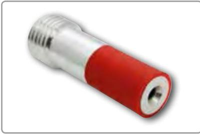
该喷嘴采用热压碳化硼内衬，具有良好的化学性能和耐磨性，是石榴石、氧化铝和钢砂等磨料的理想选择。除了耐热和耐腐蚀性外，喷嘴的铝护套使其重量较轻，橡胶套管具有减震功能，可有效保护内衬。嘴座配有橡胶垫圈。
